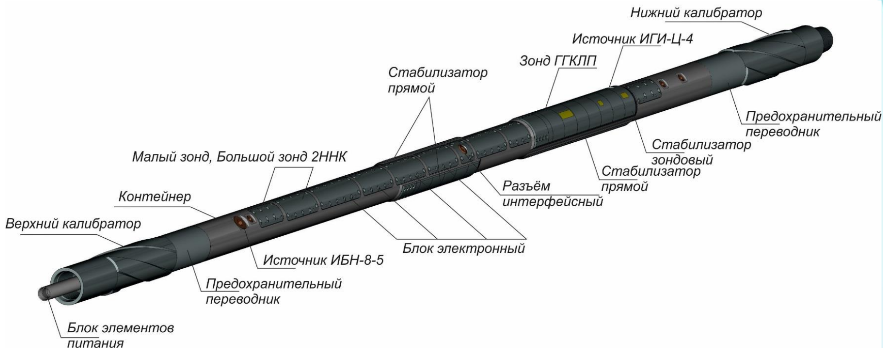
Внешний вид аппаратуры типа LWDXXX-2ННК-ГГКЛП
