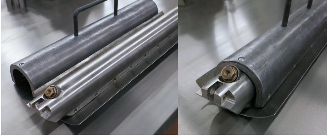
Рисунок 2 Геометрия измерения с применением свинцового «домика»
