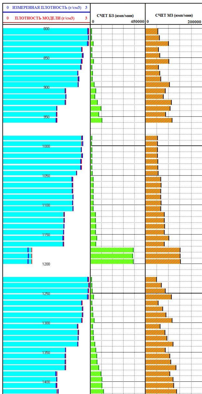
Рис. 1. Результаты работ аппаратурой АПГГК-90Р на моделях 4л, полупластах, с имитаторами глинистых корочек.
